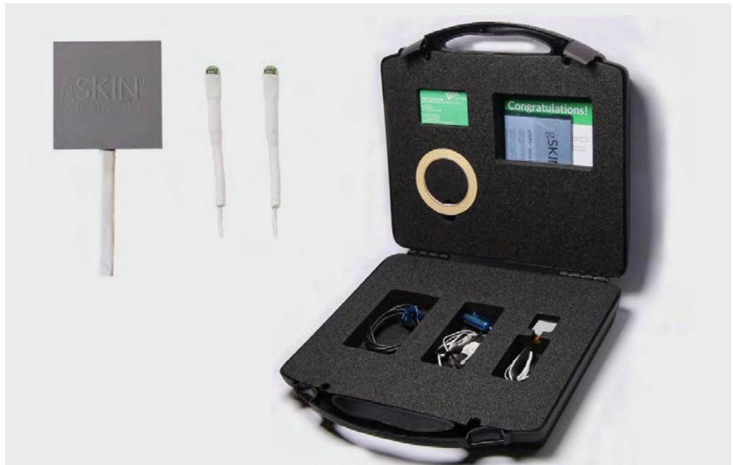
Sin embargo, ¿Cuál es la forma de medir el valor U? La termo-flujometría como herramienta de medición utiliza un sensor de flujo de calor y dos sensores de temperatura que otorgan fiabilidad y rapidez de resultados. Este enfoque ha sido estandarizado en las normas ISO 9869, ASTM C1046 y ASTM C1155. Este es un método que proporciona información cuantitativa fiable in situ de la envolvente del edificio.
