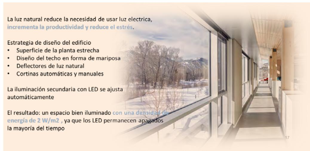
NO tienen un sistema de calefacción ni de aire acondicionado convencional. Tan solo calientan con un intercambiador de calor el aire que renuevan al medio día durante el invierno, su potencia es de tan solo 7.000 w para una superficie de 4.000m<sup>2</sup>.
