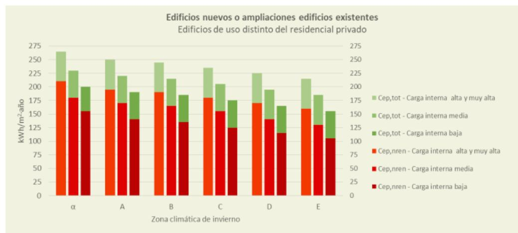
Estas gráficas muestran de una forma global el límite de Consumo de Energía total  $C_{ep,tot}$ , y su relación con el Consumo de Energía Primaria  $C_{ep,nren}$ . De las cuales se obtienen varias conclusiones:
