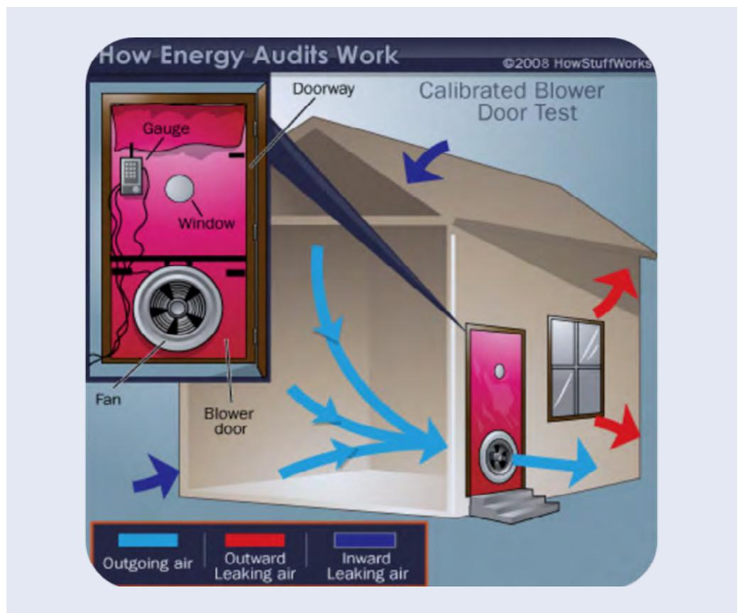
Para detectar con precisión las infiltraciones se puede recurrir durante la despresurización generada por el equipo BlowerDoor a la realización de una inspección de la envolvente del edificio para lo cual se puede contar con la ayuda de:
